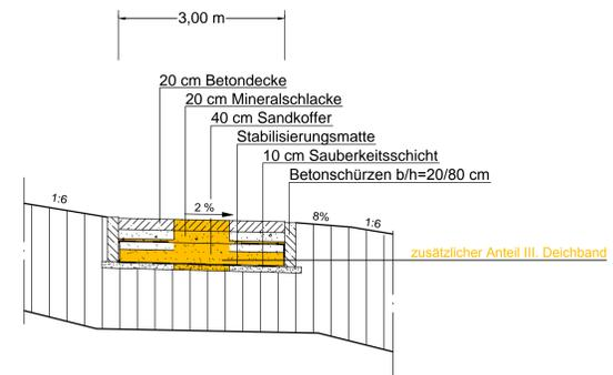
Querschnitt Binnentritt M. 1: 50
