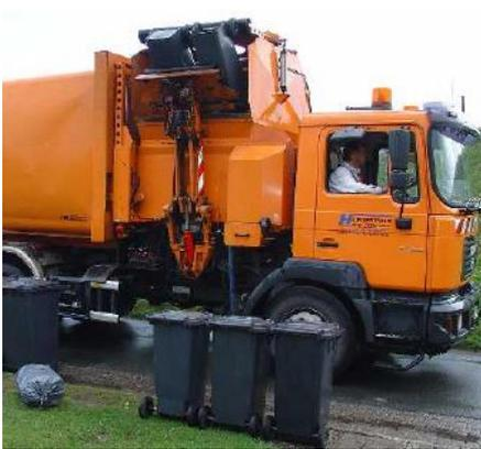
Abbildung 7: Seitenlader-Müllfahrzeug <sup>21</sup>
